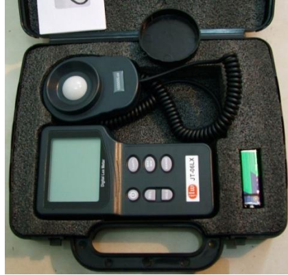
لوکس متر جهت اندازه گیری شدت روشنایی نور محیط
